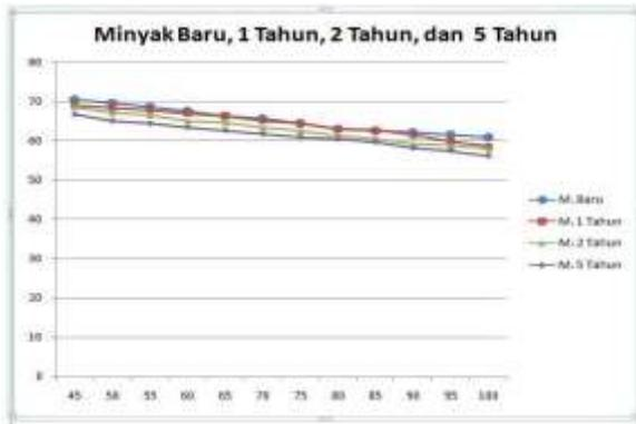
Gambar 10. Hasil pengujian tegangan tembus
