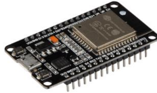
Gambar 3. Bentuk Fisik Module ESP32 (Prastyo, 2019).
