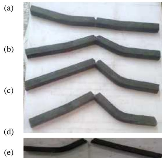
Gambar 6. Spesimen hasil uji impact dengan sudut takik  $30^\circ$ : (a) sudut awal  $30^\circ$ , (b) sudut awal  $40^\circ$ , (c) sudut awal  $50^\circ$ , (d) sudut awal  $60^\circ$ , dan (e) sudut awal  $70^\circ$
