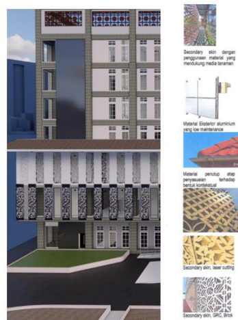
Gambar 10. Desain Material Cutting plat pada Fasad Sumber: Dokumen Pribadi
