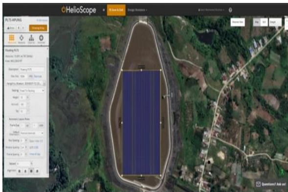
Gambar 3. Desain Solar panel Regulating Pond PLTA Renun Dengan Helioskop
