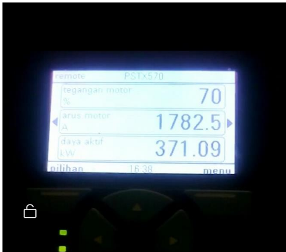
Gambar 4. Tampilan Module Display&Key , terlihat Puncak Arus Start
